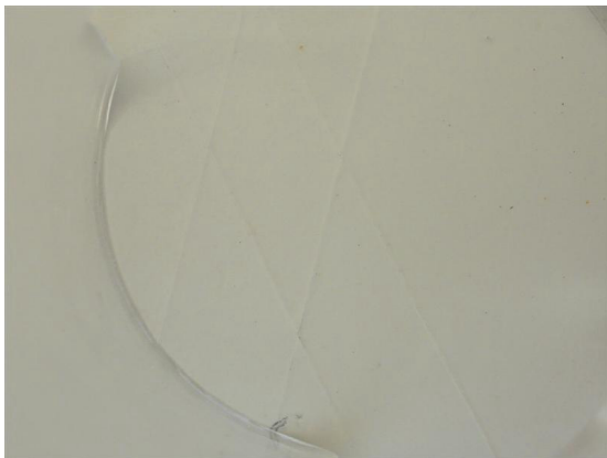
Gesloten insnijdingen en licht opgekrulde verlagen rond de insnijdingen na 24 vochtbelasting.
