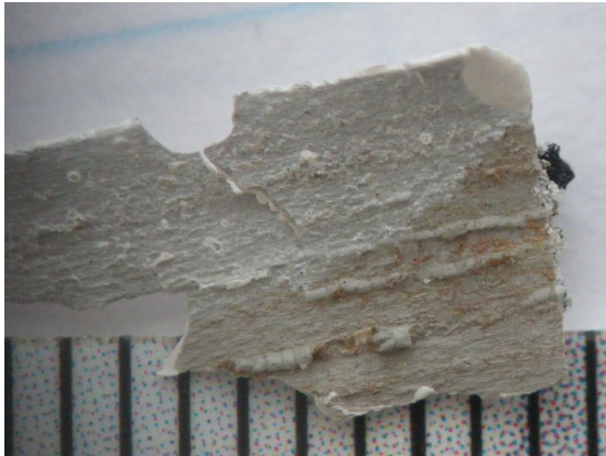
Verkleuring achterzijde afgebladderde verlaag.
